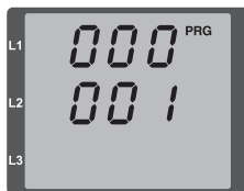
Рис. Режим программирования Индикация параметров С помощью кнопок 1 и 2 можно изменять отдельные параметры (см. стр. 36).
