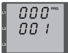
Рис. Режим программирования Индикация параметров С помощью кнопок 1 и 2 можно изменять отдельные параметры (см. стр. 48).
