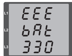
Рис. Ошибка часов/батарей с номером 330 (часы стоят, их необходимо настроить)
