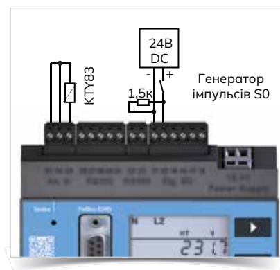
Рис.: Приклад температурного входу (КТУ83) та імпульсного перетворювача S0
